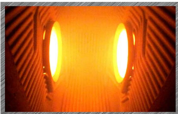
Фото 1 — Выхлоп через газоотводящие окна камер сгорания дубль-топки
